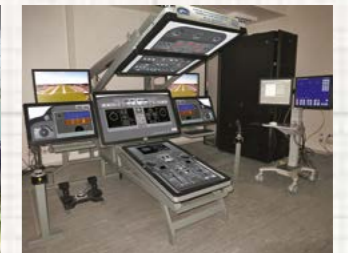
Стенд виртуального прототипирования информационного поля кабины самолета
